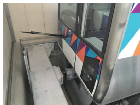
▲ 車止めに衝突した車両
